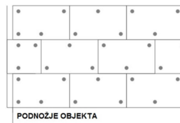
5 pričvrstnica/ploča ili 8 kom/m 2 fasade
